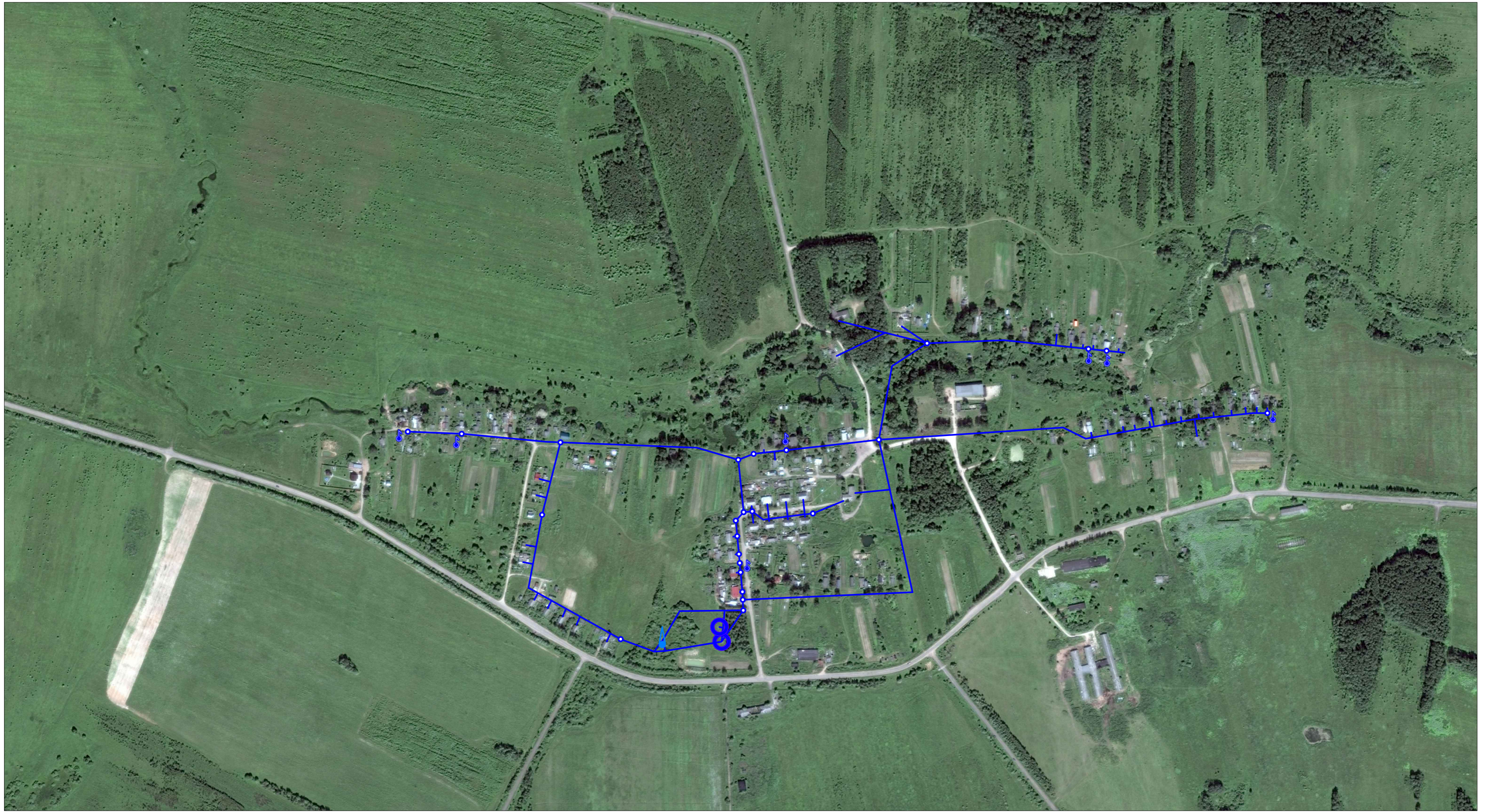
Схема водоснабжения и водоотведения с. Вятское и д. Кондреево - фрагмент территории М 1:5 000
